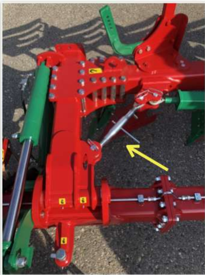
Механическая настройка 1-ого корпуса
